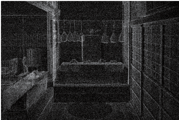
室内も、実際の建物と小道具をあわせてレーザースキャンにより3D点群データ化しました。
